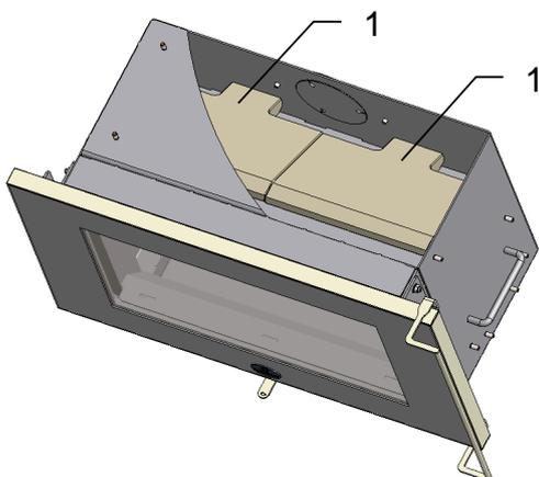
Die beiden Umlenkplatten (1) müssen wie abgebildet montiert sein.
