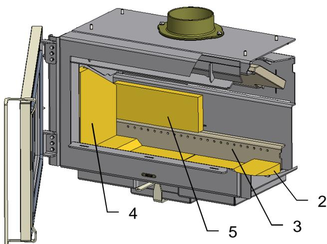
Primärluftleiste (3) mit den Luftaustrittsöffnungen oben in den Spalt zwischen den Bodenplatten (2) und der Ofenrückwand einsetzen und ausmitteln.
