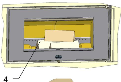
Der Abbrand einer Brennstoffmenge (4) von 1,6 bis 1,7 kg (entspricht ca.3 Stk. Holz Scheit) dauert je nach Brennstoffqualität, Schornstein- und Witterungsbedingungen ca. 40 bis 45 Minuten. Nach Abbrand und Erreichen der Grundglut kann eine neue Brennstoffmenge aufgelegt werden.
